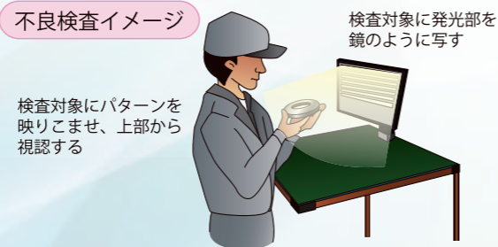
検査対象に発光部を映りこませ、不良箇所に映りこむパターンの違いで不良を発見できる
